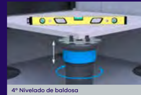
4° Nivelado de baldosa
