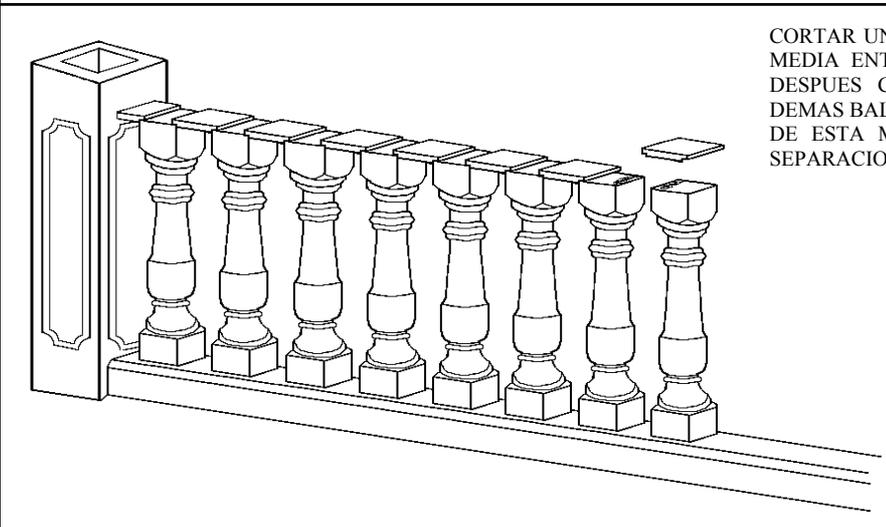
CORTAR UNA TAPA NIDO POR LA MITAD Y COLOCAR MEDIA ENTRE EL PILAR Y EL PRIMER BALAUSTRÉ, DESPUÉS COLOCAR LAS TAPAS NIDO ENTRE LOS DEMÁS BALAUSTRÉS PEGANDOLAS CON MORTERO. DE ESTA MANERA LAS TAPAS NIDO NOS DAN LA SEPARACION ENTRE LOS BALAUSTRÉS
