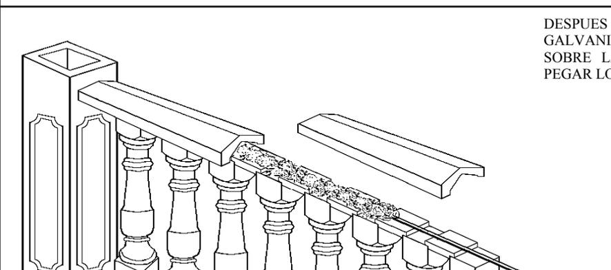
DESPUÉS COLOCAR LAS VARILLAS DE HIERRO GALVANIZADO DE 3 m/m, DISTRIBUIR MORTERO SOBRE LAS TAPAS NIDO Y LOS BALAUSTRÉS Y PEGAR LOS PASAMANOS.
